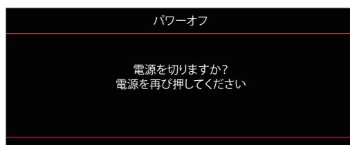
3. [電源] ボタンを再び押して確認します。ボタンを押さない場合、10 秒後にメッセージが消えます。2 回目に [電源] ボタンを押すと、プロジェクターはシャットダウンします。
